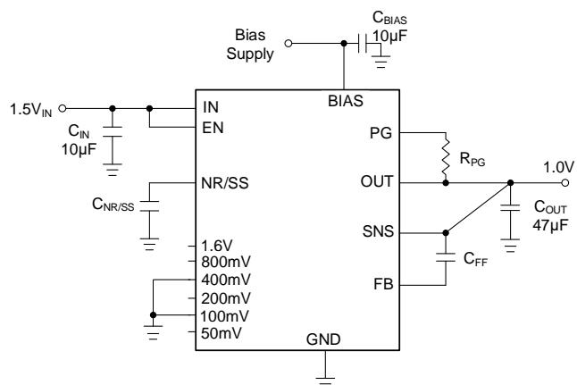
图 29 无需外部电阻的输出电压设置
