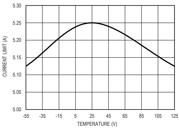
图 18. GM1203-3 输出限流值和温度的关系
