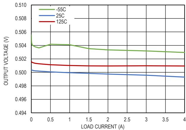
图 9. 负载调整率,  $V_{BIAS} = 5V$
