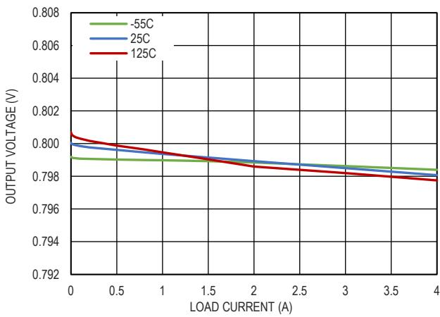
图 27. 负载调整率,  $V_{BIAS} = 5V$
