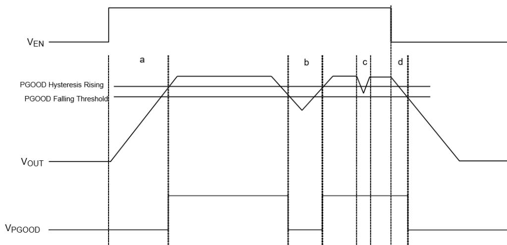
图 31 .PG 触发场景具有不同的运行状态
