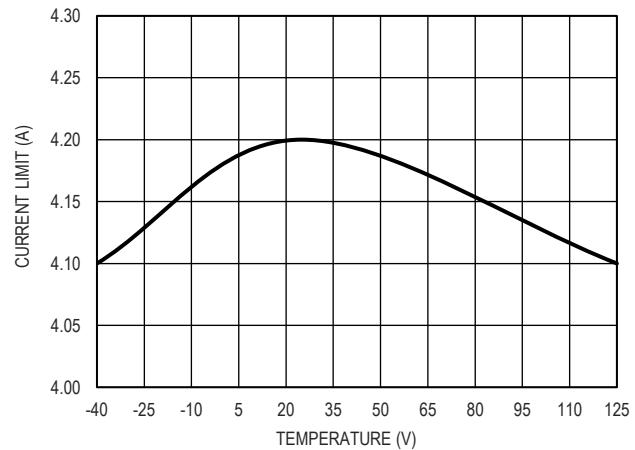
图 17. 输出限流值和温度的关系
