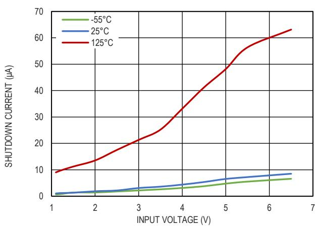
图 14. 停机静态电流和输入电压的关系
