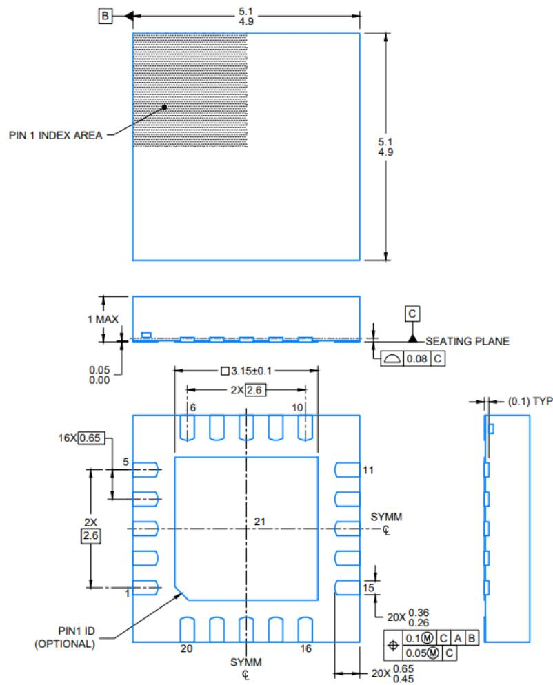
图 36.20 引脚 QFN (5 毫米 x 5 毫米)
