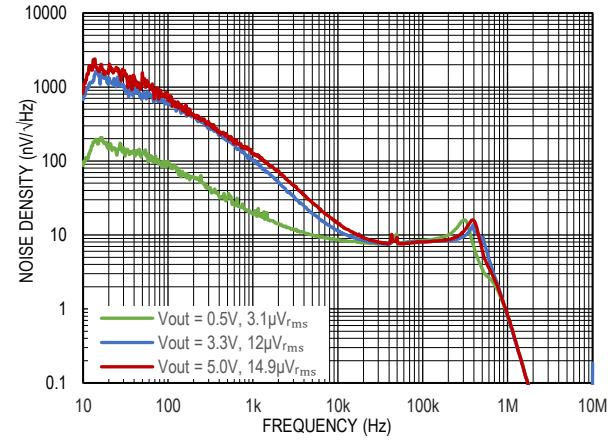
图 22. 输出噪声谱密度,  $V_{IN}=5V$ ,  $V_{OUT}=3.3V$
