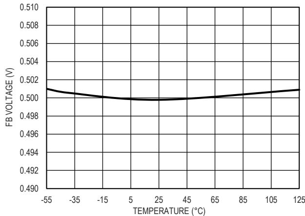
图 7. FB 引脚电压和温度的关系
