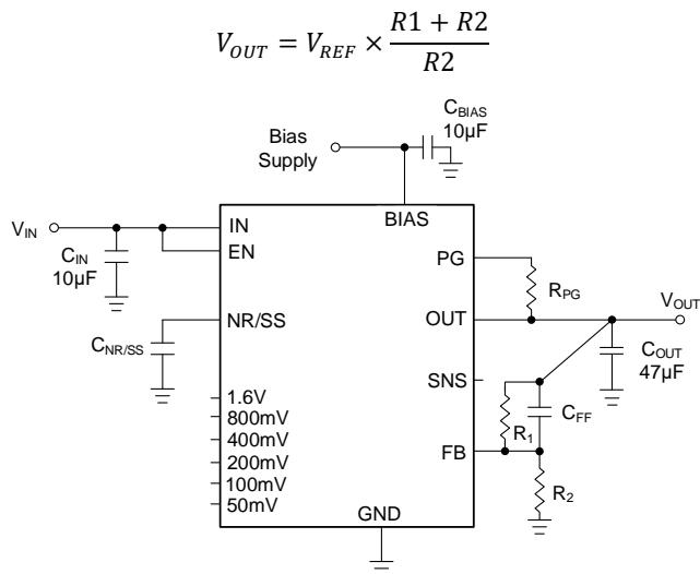
图 28 由外部电阻决定的输出电压
