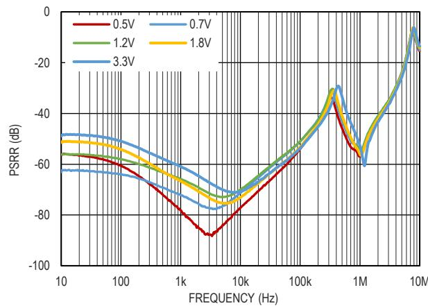
图 21. PSRR,  $V_{IN} = V_{OUT} + 0.4V$ ,  $I_o = 3A$
