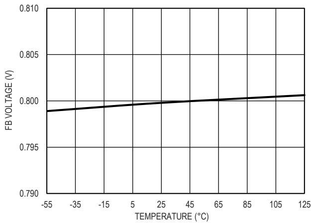
图 25. FB 引脚电压和温度的关系
