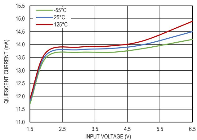
图 13. 静态电流和输入电压的关系,  $I_{OUT}=1\text{mA}$
