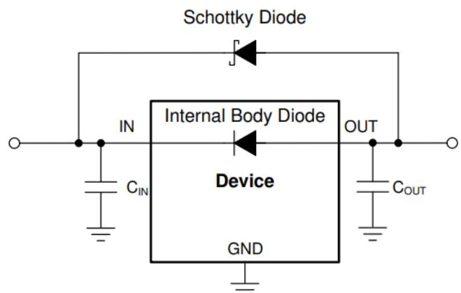
图 32. 反向电流保护应用电路
