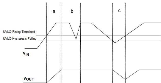
图 30 欠压锁定条件和输出变化
