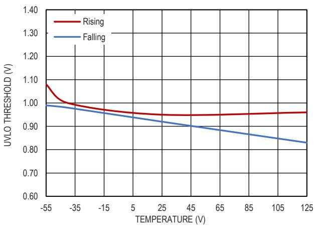
图 16. UVLO 阈值,  $V_{BIAS} = 5\text{V}$
