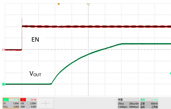
图 21. 软启动, V_{IN}=4.3V , V_{OUT}=3.6V , I_{OUT}=200mA
