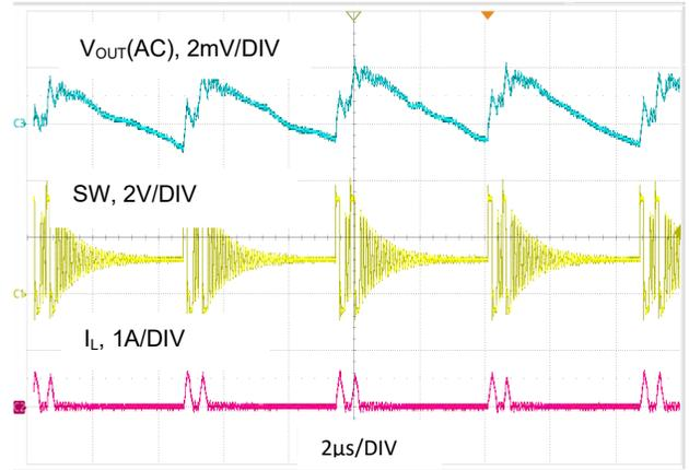
图 24.  $V_{OUT} = 1.2V$ ,  $I_O = 100mA$ , PSM 模式
