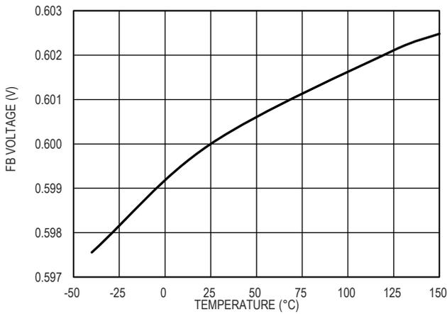
图 13. FB 引脚电压和温度的关系
