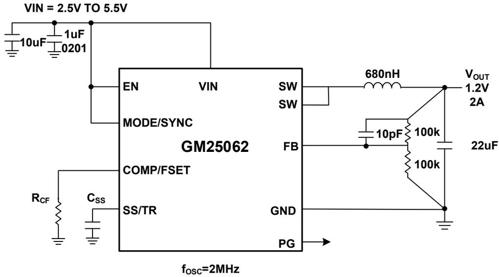
图 36. 2MHz, V<sub>IN</sub>=3.3V, V<sub>OUT</sub>=1.2V, I<sub>LOAD</sub>=2A
