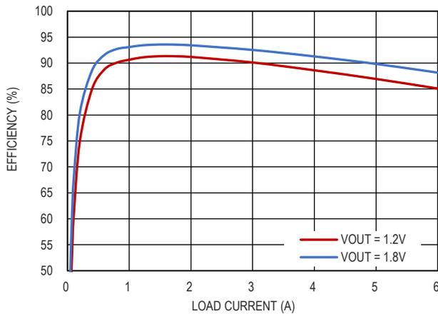
图 11. 效率曲线,  $V_{IN} = 3.3V$ ,  $F_{sw} = 4MHz$ , FPWM
