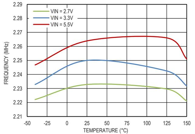
图 16. 频率和温度的关系,  $R_T$  接低
