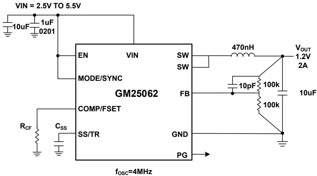
图 37. 4MHz, V<sub>IN</sub>=3.3V, V<sub>OUT</sub>=1.2V, I<sub>LOAD</sub>=2A
