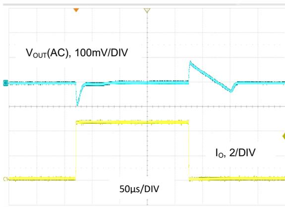
图 27.  $V_{OUT} = 1.2V$ ,  $I_O = 0.1A$  至  $4.5A$ , PSM 模式
