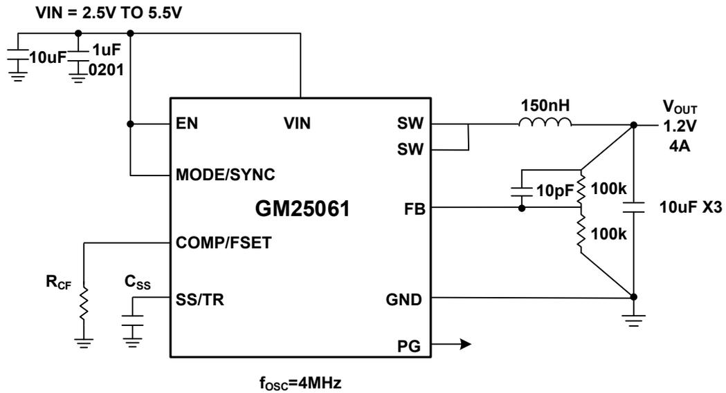
图 35. 4MHz, V<sub>IN</sub>=3.3V, V<sub>OUT</sub>=1.2V, I<sub>LOAD</sub>=4A
