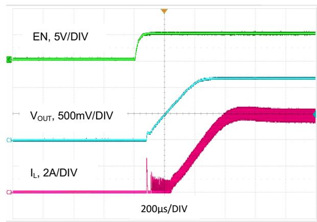
图 22. 启动波形,  $V_{OUT} = 1.2V$ ,  $I_o = 6A$
