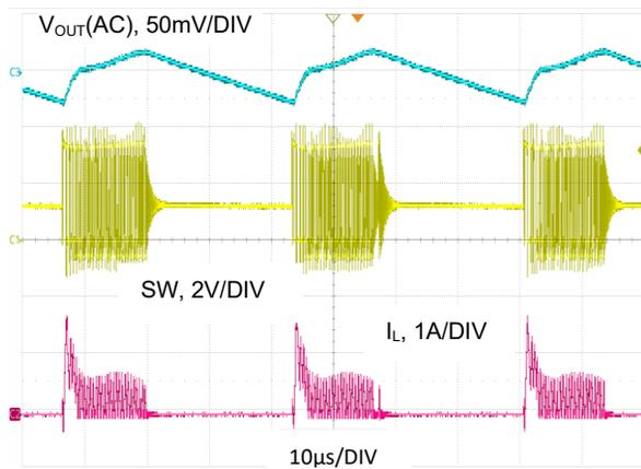
图 25.  $V_{OUT} = 1.2V$ ,  $I_O = 10mA$ , 低功耗模式
