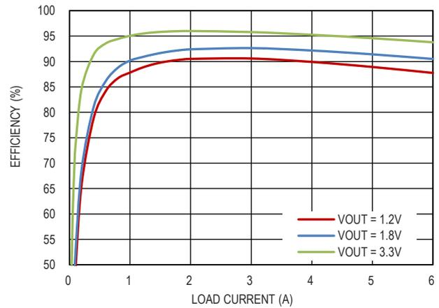
图 10. 效率曲线,  $V_{IN} = 5V$ ,  $F_{sw} = 2MHz$ , FPWM
