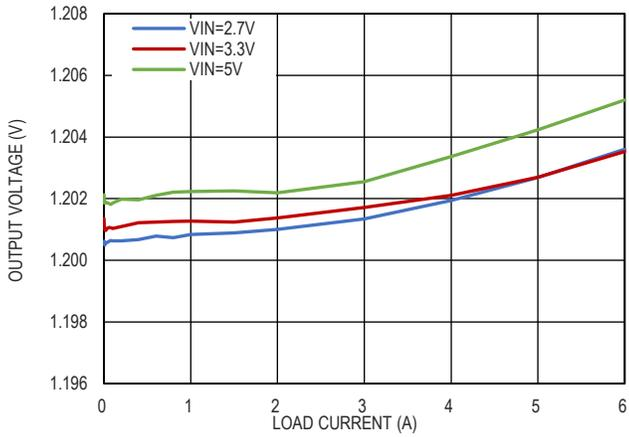
图 17. 输出电压负载调整率,  $V_{OUT} = 1.2V$
