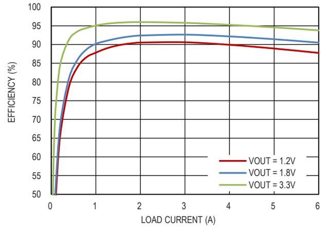
图 12. 效率曲线,  $V_{IN} = 5V$ ,  $F_{sw} = 4MHz$ , FPWM
