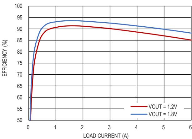
图 9. 效率曲线,  $V_{IN} = 3.3V$ ,  $F_{sw} = 2MHz$ , FPWM
