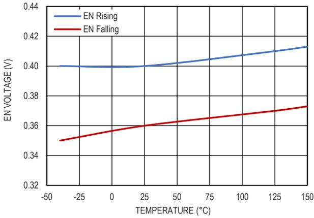
图 19. EN 阈值和温度的关系
