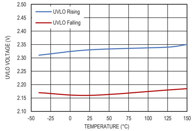
图 20. UVLO 阈值和温度的关系
