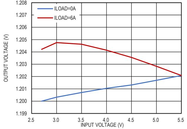
图 18. 输出电压线调整率,  $V_{OUT} = 1.2V$
