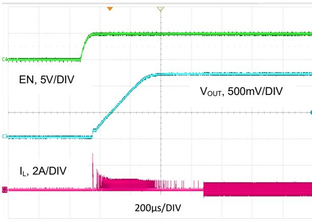
图 21. 启动波形,  $V_{OUT} = 1.2V$ ,  $I_o = 10mA$
