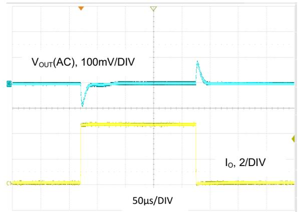
图 26.  $V_{OUT} = 1.2V$ ,  $I_O = 0.1A$  至  $4.5A$ , FPWM 模式
