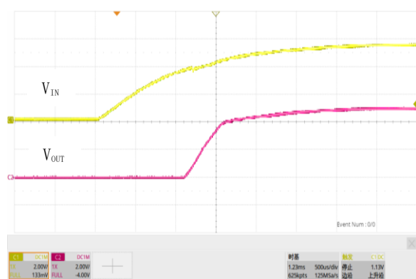
图 18. 软启动, V_{IN}=5.5V , V_{OUT}=5.0V , I_{OUT}=1.5A
