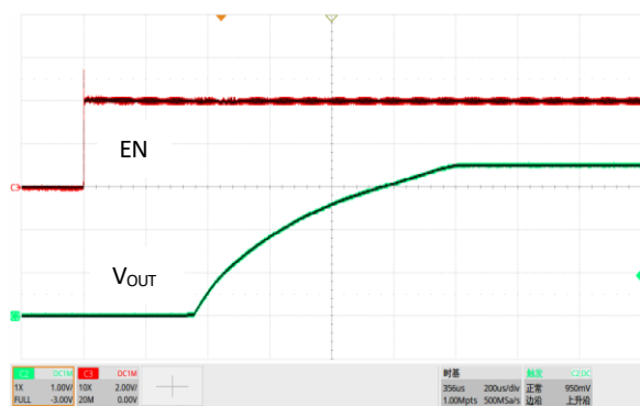
图 21. 软启动, V_{IN}=4.3V , V_{OUT}=3.6V , I_{OUT}=300mA
