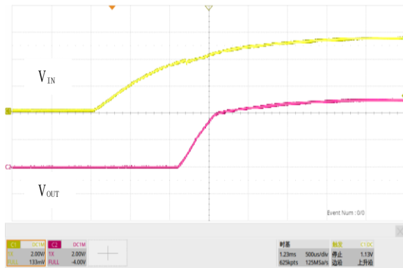
图 18. 软启动, V_{IN}=5.5V , V_{OUT}=5.0V , I_{OUT}=3A
