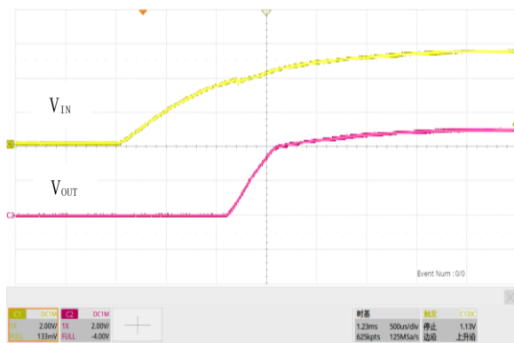
图 21. 软启动, V_{IN}=5.5V , V_{OUT}=5.0V , I_{OUT}=1.5A
