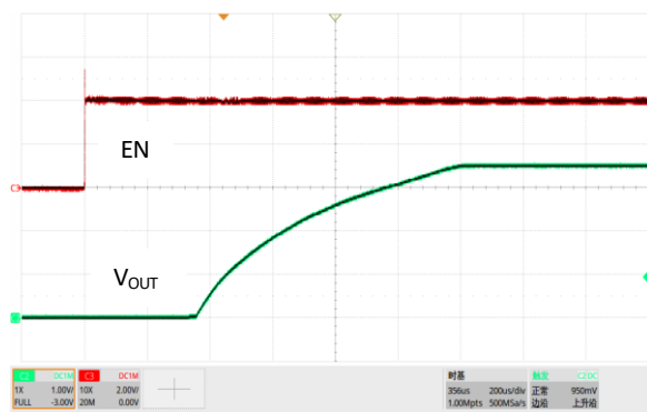
图 21. 软启动, V_{IN}=4.3V , V_{OUT}=3.6V , I_{OUT}=300mA
